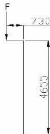
Gambar 4.8 posisi pembebanan rel
