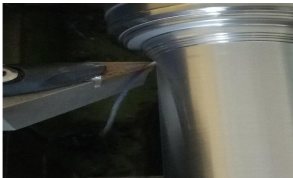
Gambar 1. Proses Pengelupasan Serpihan Bahan JIS DF-3
