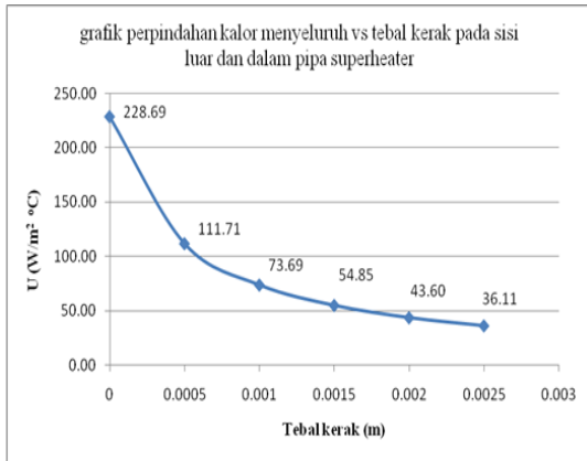
Grafik 4.3.1. koefisien perpindahan kalor menyeluruh vs tebal kerak pada pada sisi luar dan dalam pipa superheater
