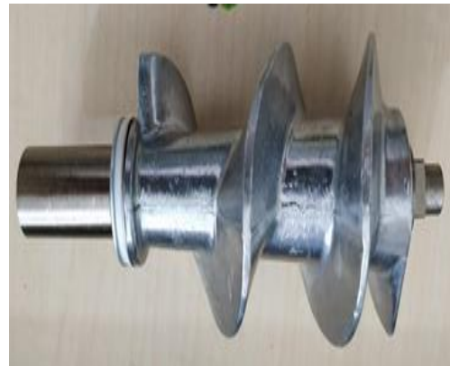
Gambar 2.5.4 Ulir penggiling daging
