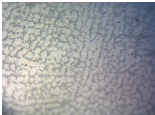
Gambar 4. 5 Pembesaran 200x Struktur Mikro Sprocket Al-7075-T6 (Heat Treatment 180°C dengan Pendingin Oli)
