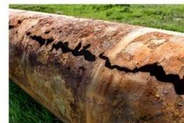
Gambar 2.6. Pipa kondensor yang mengalami korosi didalam air laut
