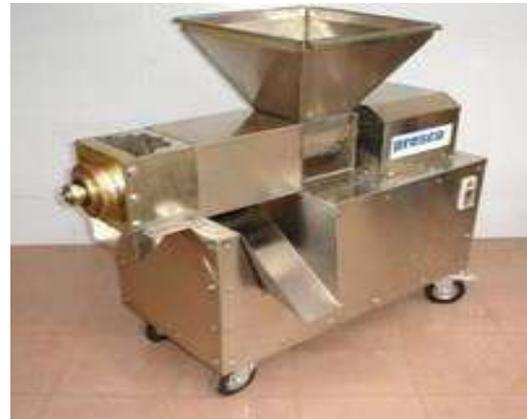
**Gambar 1: Mesin pemeras Minyak**
