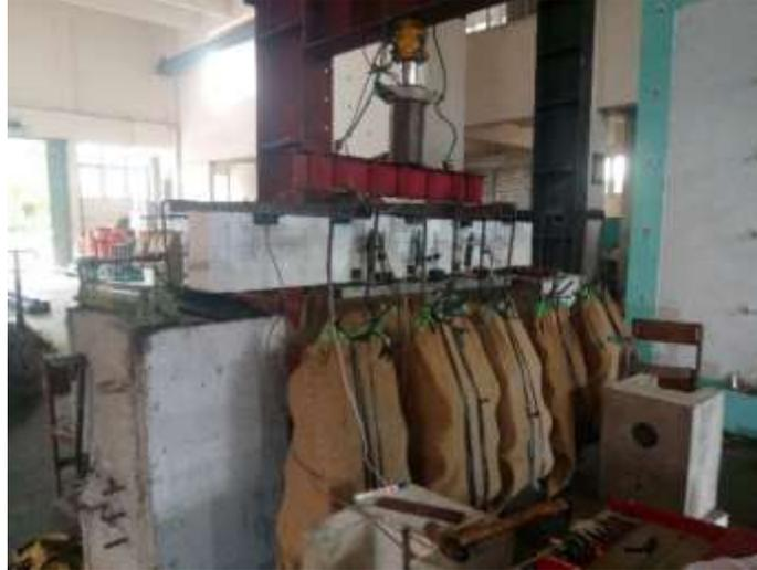
Gambar 4. Pengujian lentur benda uji
