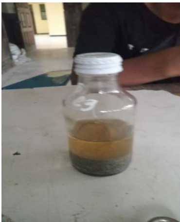
Pengujian Pasir Dengan NaOH Pengujian Kadar Lumpur Menggunakan NaOH
