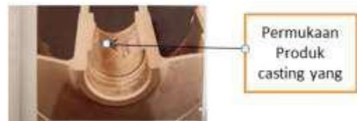
Gambar 3. Komponen Brake Drum yang gagal
