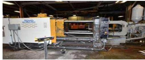
Gambar 5. Mesin Cold chamber diecasting te 350 Ton Skema mesin mesin die casting ditunjukkan pada gambar 6
