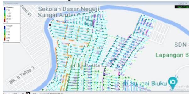
Tekanan minimum sebesar 10,67 meter memenuhi kriteria tekanan minimum pada sambungan rumah yaitu 7,5 meter sesuai dengan SNI 7509:2011. Sedangkan untuk kecepatan aliran, sebagian besar terutama pada pipa tersier dan sambungan rumah masih kurang dari kriteria minimal dalam Peraturan Menteri PUPR No.27/PRT/M/2016 yaitu minimal 0,3 meter/detik. Secara umum sebanyak lebih dari 80 % pipa yang ada memiliki kecepatan aliran kurang dari 0,3 meter/detik.
