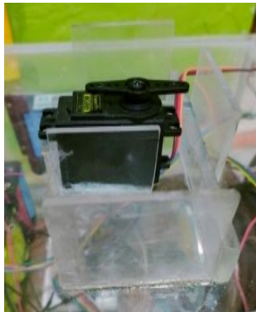
Gambar 5. dudukan motor servo
