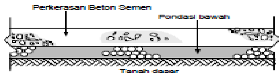
Gambar 1. Tipikal Struktur Perkerasan Beton Semen
