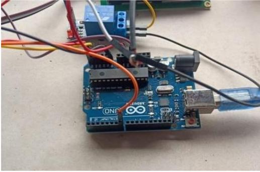
**Gambar 4.** arduino uno dan relay
