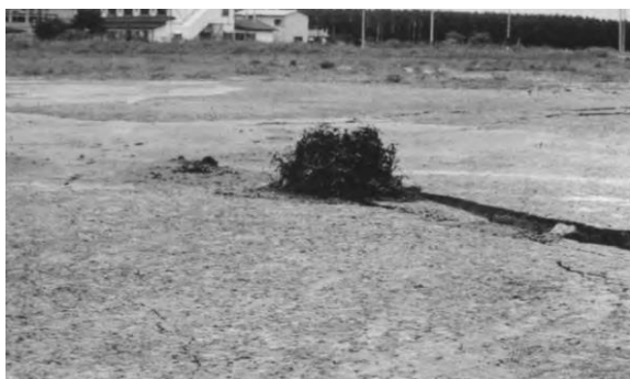
Gambar 1. Pendidihan pasir yang disebabkan oleh pencairan sedimen di bawahnya selama gempa bumi Miyagi-ken-Oki, Jepang 1978
