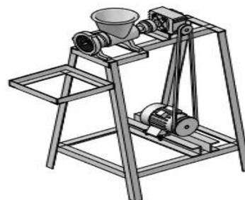
**Gambar 3.1** Kontruksi mesin penggiling ketela
