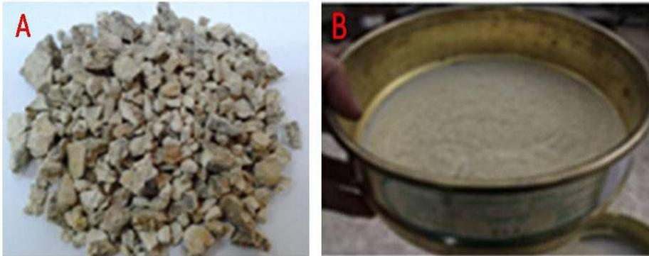
Gambar 4.1. a). Zeolit Alam dan b). Zeolit ukuran 200 mesh (74 mikrometer)
