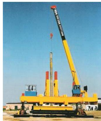
**Gambar 2. Alat Pemancangan Hydraulic Jack**
